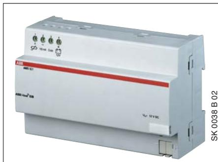
Das Akku-Modul ist ein Bleigel-Akkumulator für die Pufferung der ABB i-bus® EIB-Systemspannung zur Überbrückung von Netzausfällen. Das Akku-Modul kann nur in Kombination mit der unterbrechungsfreien EIB-Spannungsversorgung SU/S 30.640.1 eingesetzt werden. Das Akku-Modul ist ein Reiheneinbaugerät und kann im Verteiler einfach unter der SU/S 30.640.1 auf die Tragschiene aufgeschnappt werden.
